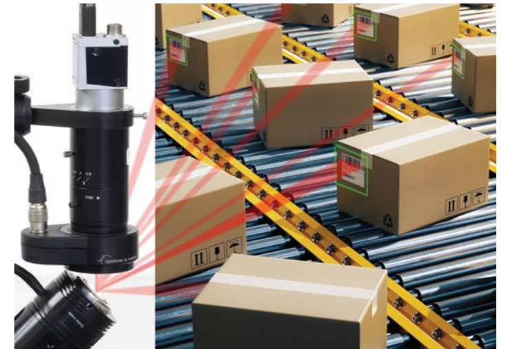
光束控制振鏡與液態鏡頭結合，可用於視野拓展與AOI選擇等應用
